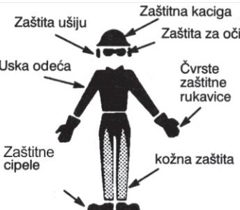
Prilikom rada uvek upotrebljavajte zaštitnu opremu. Uvek upotrebljavajte sigurnosne neklizajuće cipele sa čeličnom zaštitom prstiju, usku odeću, čvrste zaštitne rukavice, zaštitne naočare ili vizir, zaštitu ušiju (slušalice ili čepove za uši) i atestiranu kacigu. Ukoliko imate dugačku kosu, vežite istu iznad ramena.
